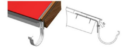
Ulkopuolisen kannakkeen häntäkoukku, joka kiinnitetään katteen alle.
